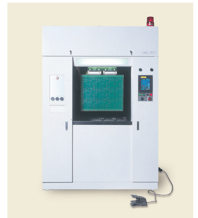
縦型ソルダーコータ「HAL-311」 垂直型热风整平机「HAL-311」 Vertical Solder Coater : HAL-311
