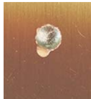
飛散数: 33個 No. of flux splash: 33
