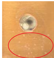
飛散数: 112個 No. of flux splash: 112
